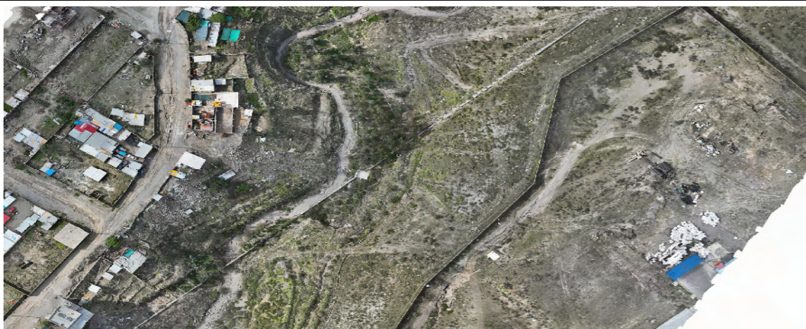
FIGURA N°01: TRAMO CRÍTICO EN LA QUEBRADA PASTO RAIZ COLMATADO POR EL EJE DEL CAUCE CONCRETO ARMADO EROSIONANDO AGUAS ABAJO
