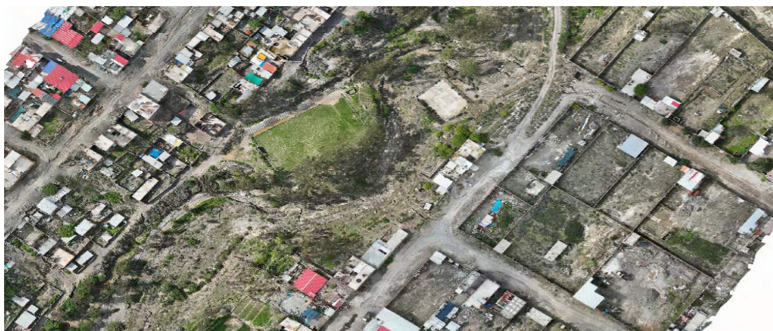
FIGURA N°03: SE OBSERVA LOS CAMPOS DE FUTBOL INUNDADOS Y EROSIONADOS EN LAS MARGENES PARA DESCOLMATACION
