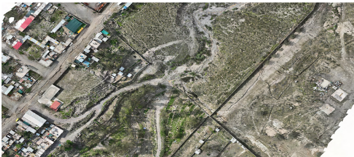
FIGURA N°02: TRAMO CRÍTICO COLMATADO Y EROSIONADO EN EL SECTOR COMPLEJO 11 DE MAYO
